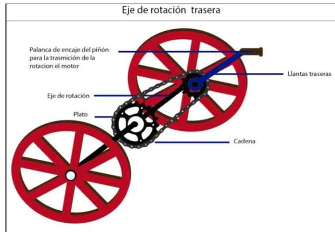
**Figura 6:** Eje de rotación trasera.
